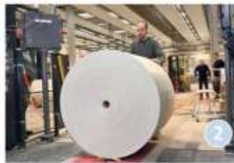
Auf dem „Schlitten“ in die Maschine: Simon Wagner schiebt die Papierrolle an die richtige Position.
