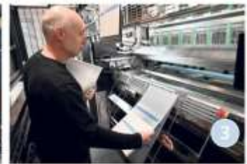
Hendrik Lülfau belichtet die Druckplatten. Für eine Zeitungssseite sind vier Platten nötig.
