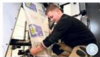
Die Zeitung wird gedruckt, geschnitten und gefaltet. Hendrik Lülfau zeigt für das Foto, wie die Papierbahn über seinen Trichter läuft.
