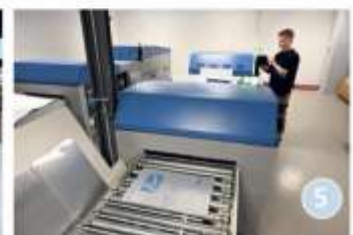
Die Platten kommen in die Druckmaschine. Markus Schmidt muss sie dafür nur einhängen.
