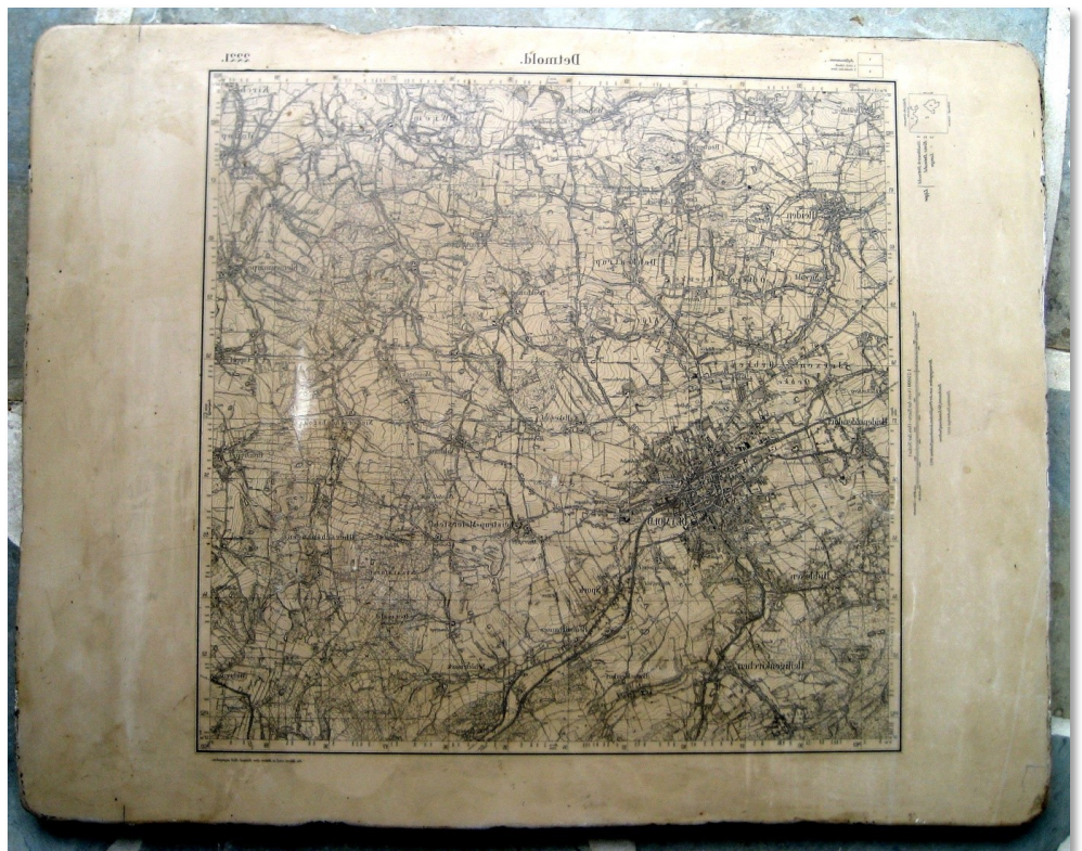
Der Originaldruckstein wiegt 28 kg. Alle Linien sind auf glattpoliertem Solnhofer Schiefer manuell geritzt worden.
